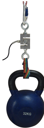
Figura 5.45: Calibración del sensor de fuerza
